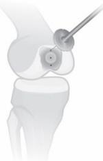
Извадете шаблона. Фрезовайте като вкарвате **фрезата Kahuna** по **2,5 mm направляващата феморална игла**, докато задната част на фрезата подмине централната част на вече фрезованата повърхност.
